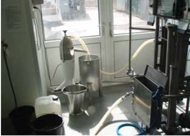
Uned sy'n hidlo'r hufen o'r llaeth. Ffynhonnell: C.E. Lloyd, Prifysgol Abertawe
