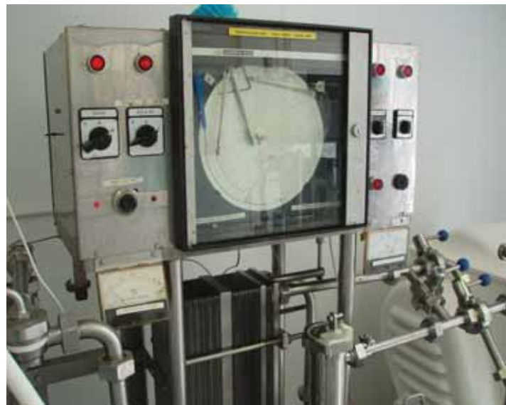
Uned basteureiddio, yn dangos mesurydd tymheredd. Ffynhonnell: C.E. Lloyd, Prifysgol Abertawe
